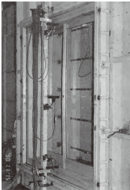
風圧 160kg/m 2 (風速約 40m の台風程度) の荷重で、 框中央部のたわみは正圧(外側に反る)で約 18mm、 負圧(内側に反る)で約 17mm が認められる。
